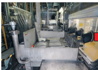
コンデンサ解体エリア素子取出解体装置（解体前→解体後）
