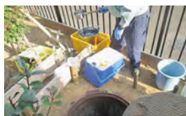
最終放流枿排水 サンプリング測定状況 (東京 PCB 処理事業所)
