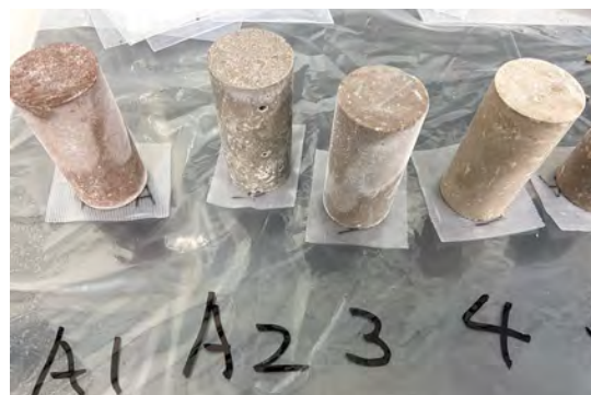
飛灰の固型化体の例 ※粘着テープの幅は約5cm
