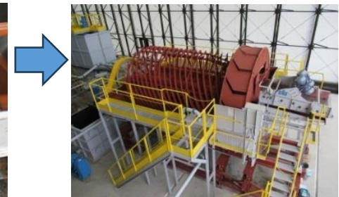
沈降分離により、砂と粘土・シルトを分別し、主に「砂」を回収する設備
