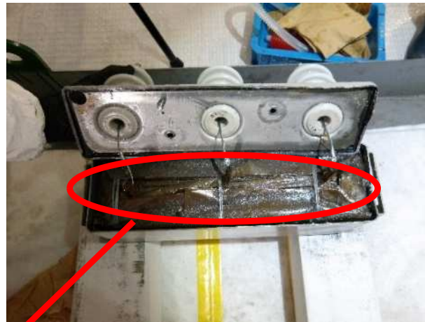
コンデンサーの解体作業
