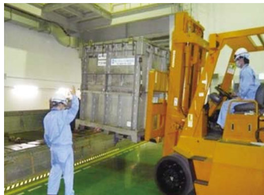
漏れ防止型金属容器をトラックから積み下ろしする様子
