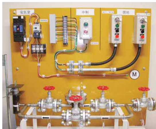
現物で作成した実地訓練用模擬装置
