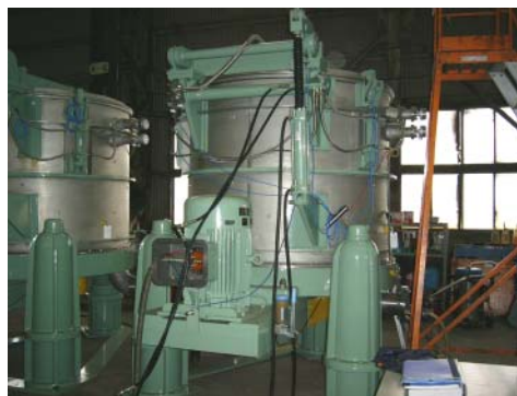
攪拌洗浄装置
