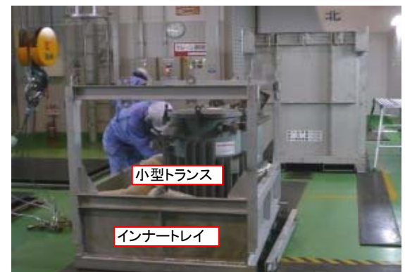
運搬容器から取り出したインナートレイ中の小型トランスの受入検査
