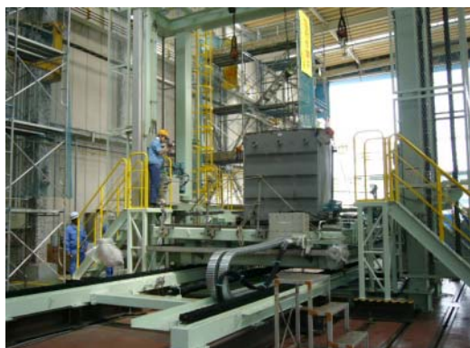
切断機(縦型バンドソー)によるトランス放熱器の切り取り
