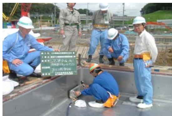
ステンレス床現地溶接部分の真空吸引テスト実施状況
