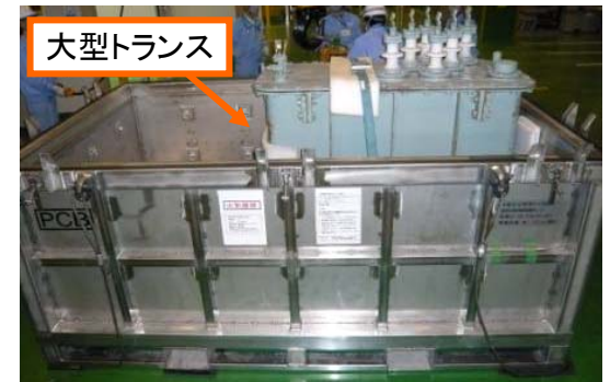
密閉容器(漏れ防止型金属容器) で搬入された大型トランス
