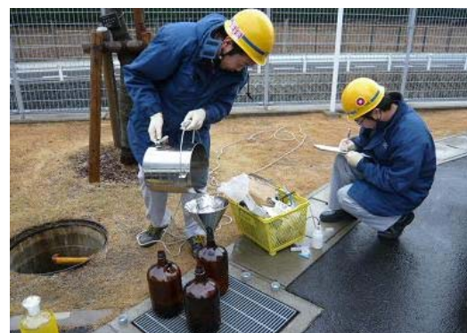
排水調査のための採水の様子
