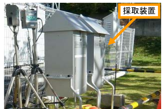
周辺大気を採取する装置 (ハイボリュームエアサンプラー)
