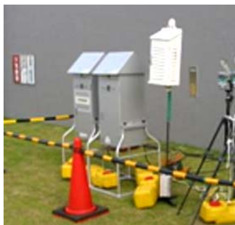
周辺大気を採取する装置 (ハイボリュームエアサンプラー)
