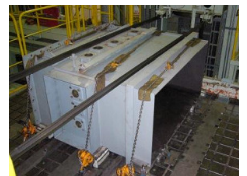
上蓋切断された缶体
