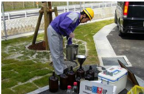
最終放流口の排水検査
