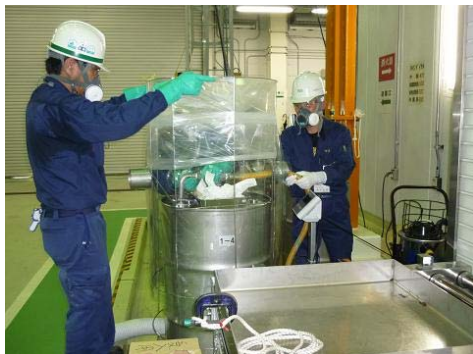
当処理施設内でのリターナブルドラム缶からの抜油の様子
