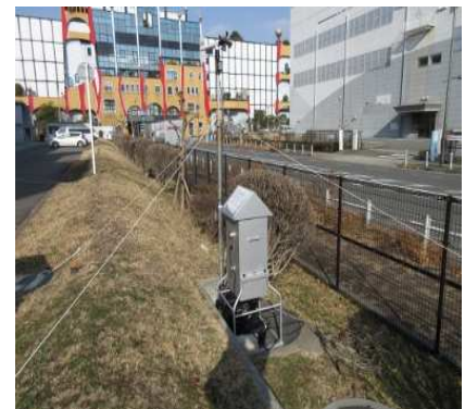
事業所敷地内での測定の様子 (風向・風速計とエアサンプラー)
