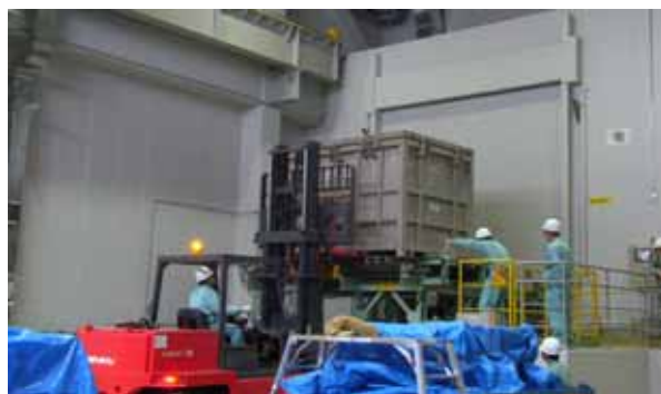
漏れ防止型金属容器を受入コンベヤで受入検査室へ移送(西棟受入室)
