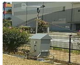
事業所敷地内での測定の様子 (風向・風速計とエアサンプラー)
